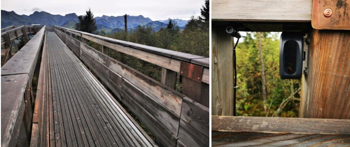
Abbildung 22: Infrarotsensoren von TRAFx und Eco-Counter in einer Vergleichszählung am Gägersteg
