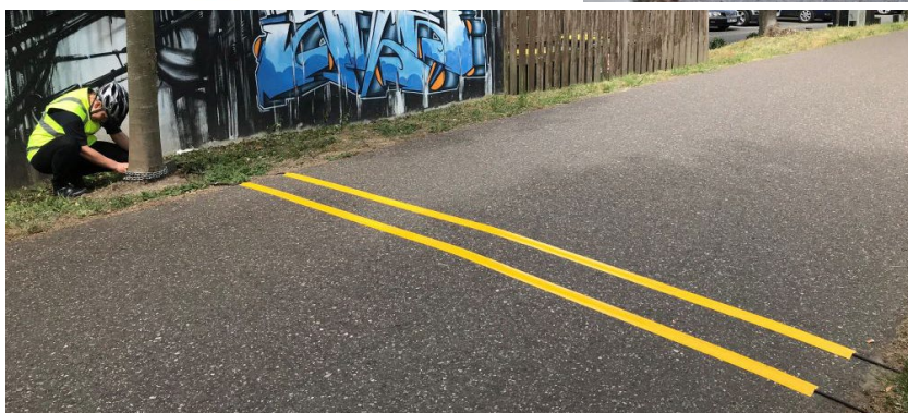
Abbildung 8: Schematische Darstellung des Systems TUBES (Grafik links) sowie ein solche im Einsatz auf Landstrassen und in Städten; gelb: Schutz bei vielen Inlineskates (Quelle: Eco-Counter)
