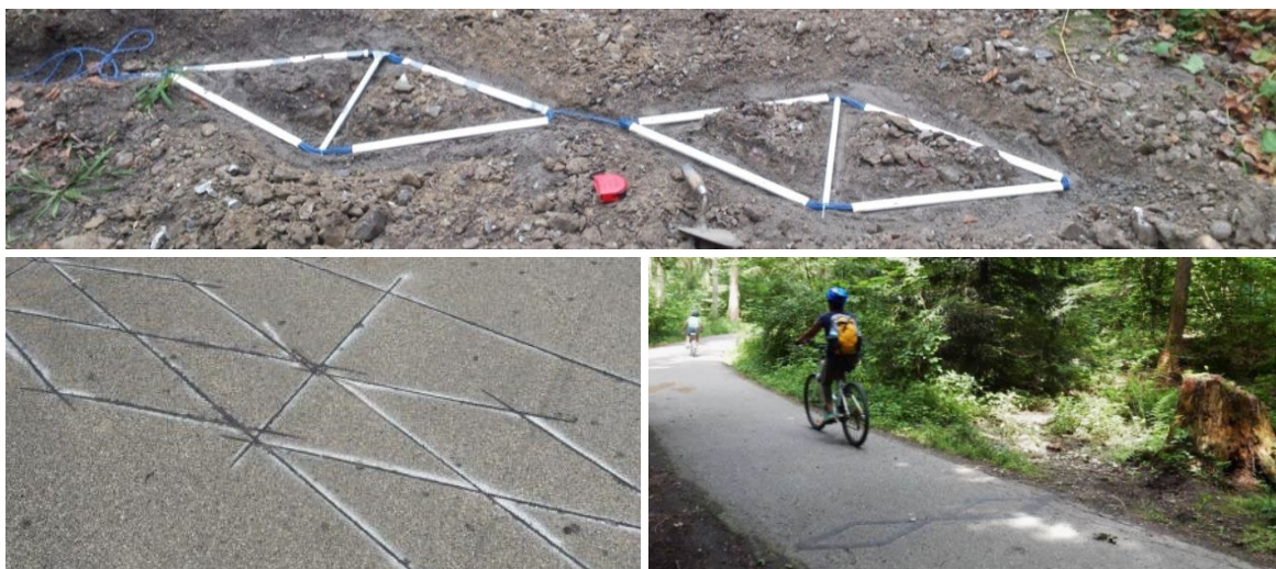
Abbildung 7: Oben: ausgelegte Schleifen (ZELT) auf einem Naturweg im Wildnispark Sihlwald (Foto: Ronald Schmidt); unten: im Asphaltbelag eingefräste Velozählstelle (links) und temporäre Zählstelle Easy ZELT im Hürstwald Zürich 2021 (rechts)
