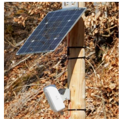
Abbildung 6: Das PCR2-Radarzählgerät (Fotos links und rechts) und die Abdeckung des Zählbereichs (Mitte) (Foto links und Grafik Mitte: Parametric)
