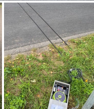
Abbildung 8: Schematische Darstellung des Systems TUBES (Grafik links) sowie ein solche im Einsatz auf Landstrassen und in Städten; gelb: Schutz bei vielen Inlineskates (Quelle: Eco-Counter)
