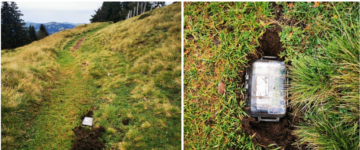
Abbildung 23: Der Mountainbike-Zähler von TRAFx (nur für sehr schmale Wege geeignet)
