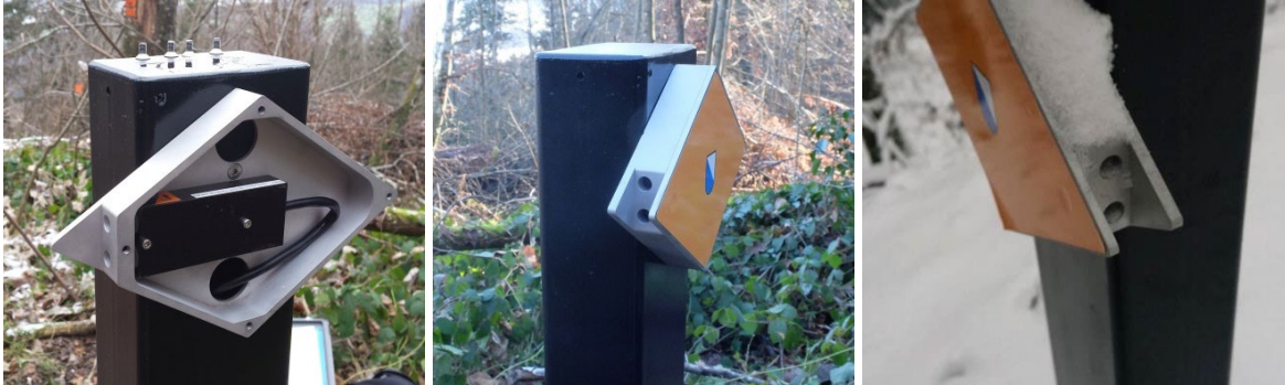
Abbildung 17: Wärmesensor versteckt in einer speziell hergestellten Wanderweg-Rhombe
