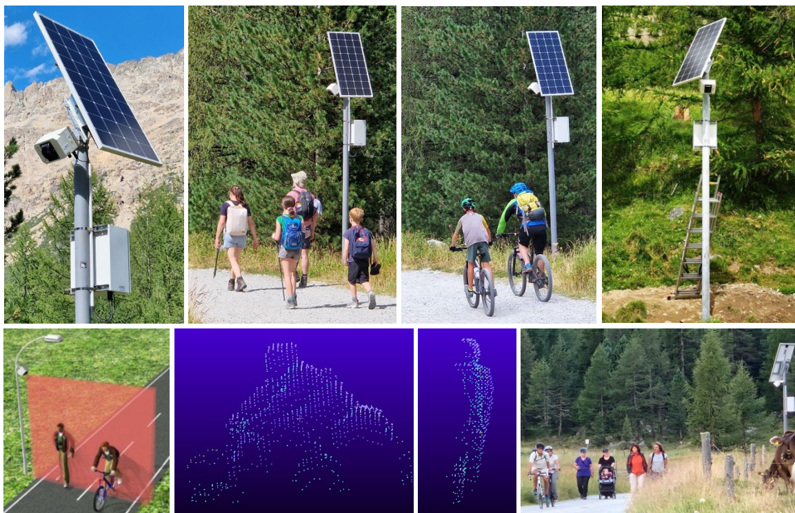
Abbildung 13: Obere Bildreihe und unten rechts: Der Laserscanner im Einsatz in Pontresina, untere Reihe: Funktionsweise des Laserscanners mit Punktwolken fürs Velo und Zufussgehende (Quelle Grafiken & Foto oben rechts: Swisstraffic).
