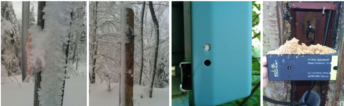
Abbildung 20: Schnee und durch Tieraktivitäten verstopfte Sensoren verdecken den Sensor (Fotos: Ronald Schmidt, Wildnispark Zürich)
