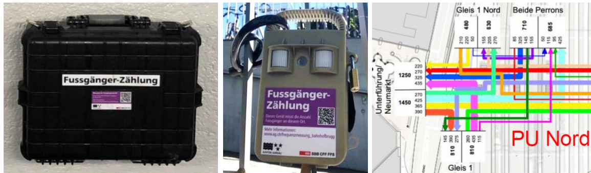
Abbildung 42: Das Bluetooth/Wifi-Erfassungsgerät links und die Wärmebildkamera zur Kalibrierung (Mitte), beides Prototypen der Universität Lausanne; rechts Ausschnitt Ergebnis (Fotos Christian Pestalozzi, Pestalozzi & Stäheli)
