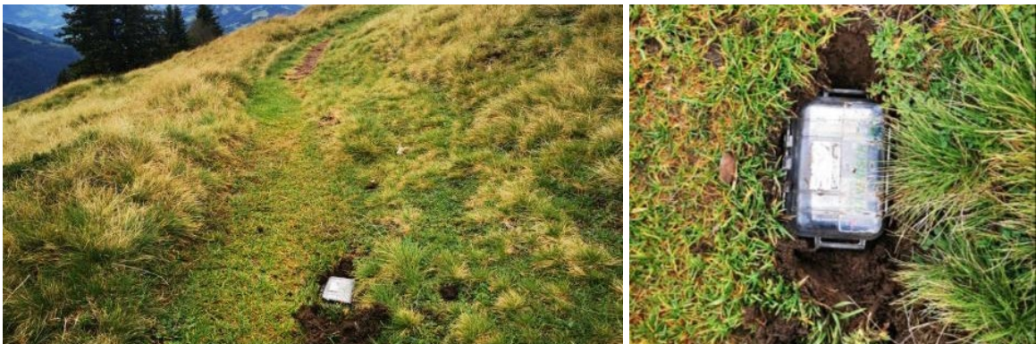
Abbildung 9: Das Magnetometer-Gerät (oben links) und die schematische Darstellung des Einsatzbereichs (oben rechts) (Quelle: TRAFx); das Gerät im Einsatz im Gantrisch-Gebiet (Quelle: Stefan Steuri, Naturpark Gantrisch)
