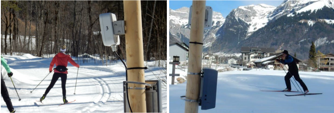
Abbildung 32: Kontroll- und Vergleichszählungen von Parametric- und Eco-Counter-Zählgeräten entlang der Langlaufloipen in Engelberg im März 2022
