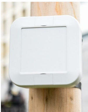
Abbildung 6: Das PCR2-Radarzählgerät (Fotos links und rechts) und die Abdeckung des Zählbereichs (Mitte) (Foto links und Grafik Mitte: Parametric)
