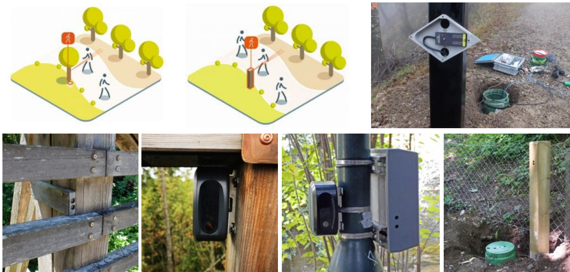
Abbildung 3: Pyrosensoren im Feldeinsatz; oben links: schematische Darstellung der Funktionsweise (Eco-Counter)
