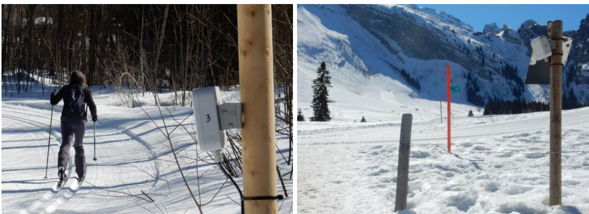
Abbildung 30: Das Zählgerät im Wintereinsatz: links zur Zählung von Langlaufenden, rechts an einem Winterwanderweg
