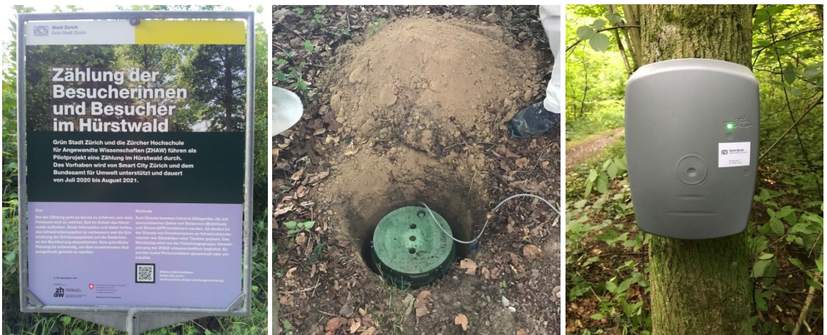
Abbildung 34: Plakat zur Information der Waldnutzenden, Schacht für Logger & Batterie (Mitte), Pyro-Sensor
