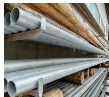
Ill. 14 Barres métalliques, longueur 6 m, diamètre 2 pouces – en réserve, à couper en fonction des besoins
