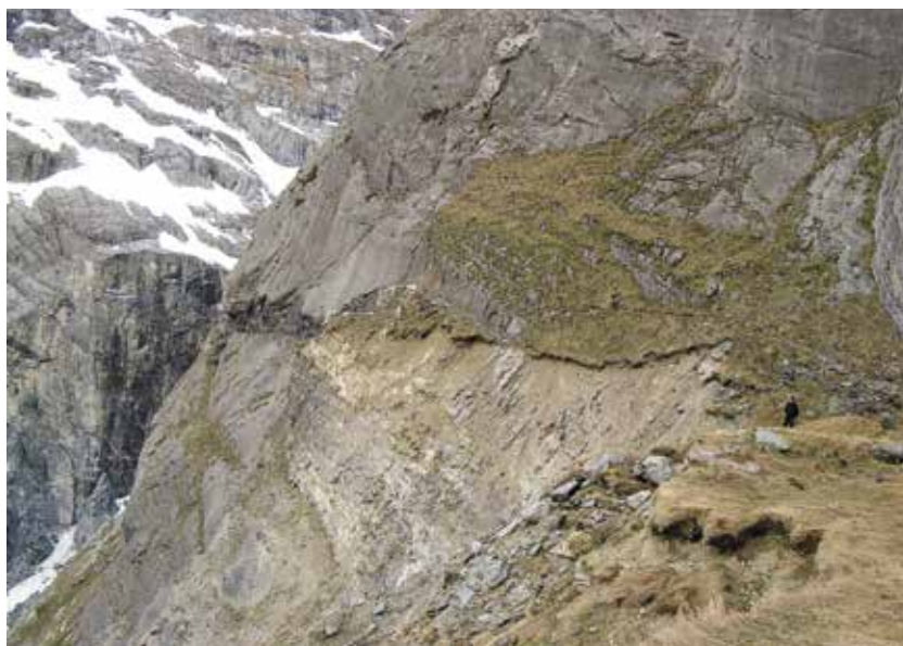
Fenditura che segnala il rischio di frana di scorrimento rapido (sentiero alpino Bäregg-Schreckhornhütte).
